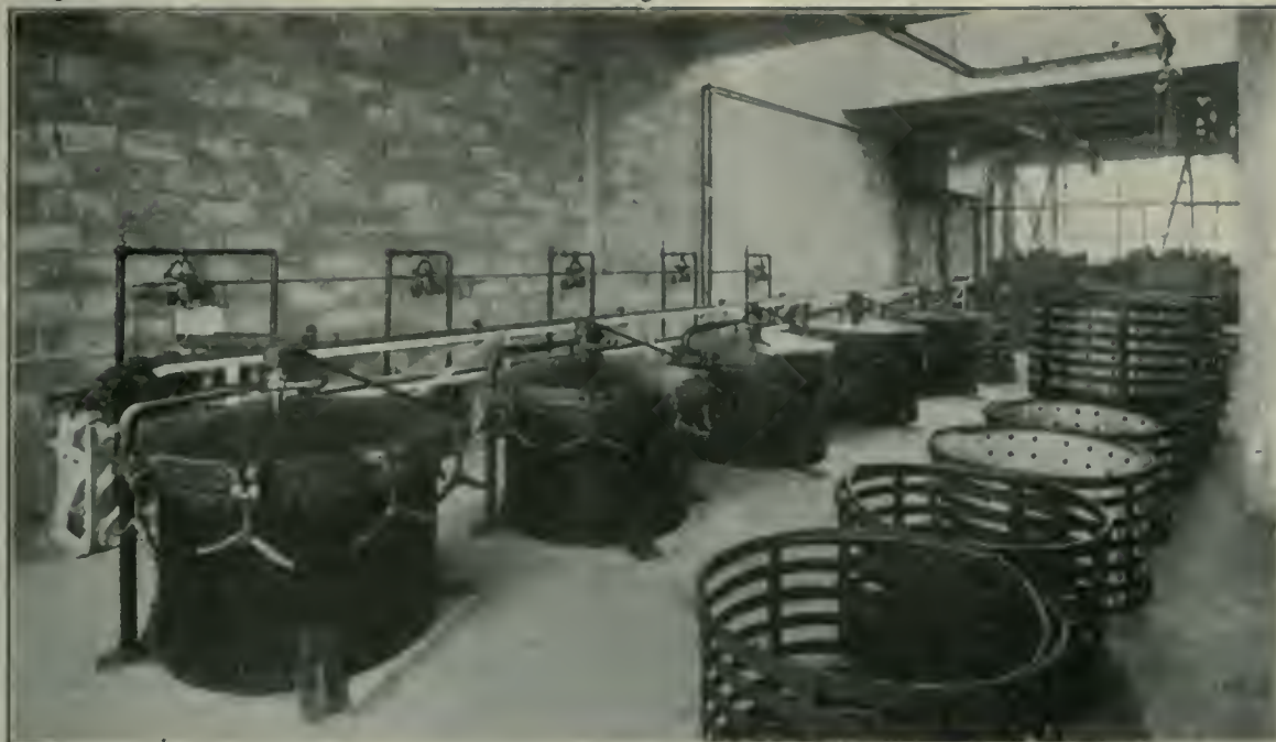
Retorts for Cooking Sardine-Herring, New Brunswick Cannery Cornues pour Cuire la Sardine-Hareng, dans une Fabrique au Nouveau Brunswick. Retortas par Cocer la Sardina-Arenque en una Fábrica de Nueva Brunswick
