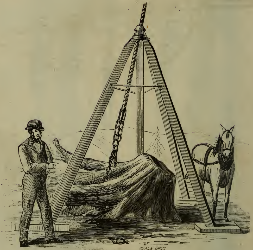
SCREW STUMP MACHINE, (See p. 501.)
