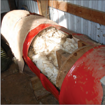
Fig. 15. Horizontal wool press
