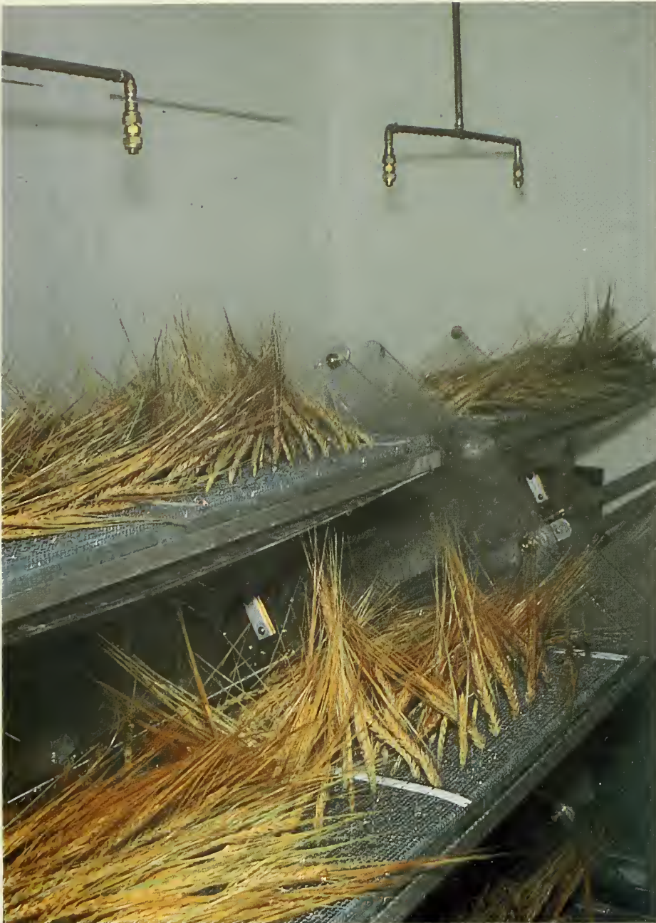
Figure 2 Échantillons d'orge subissant le traitement du simulateur de pluie
